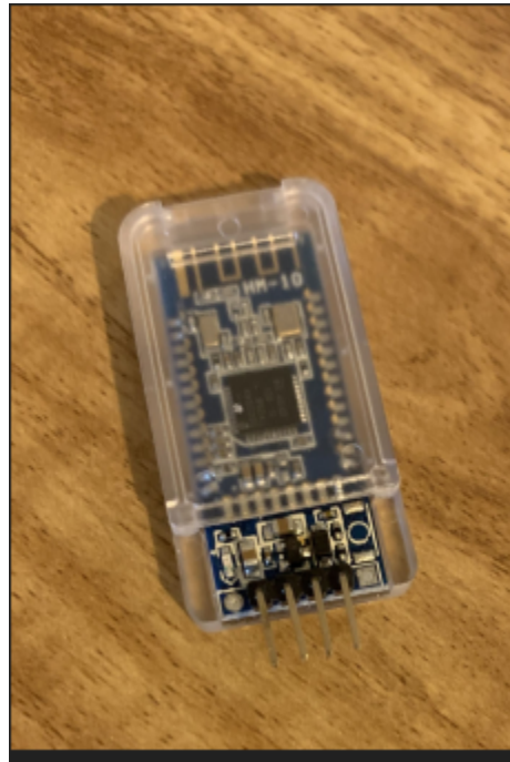
Figure 45: HM-10 BLE Module
