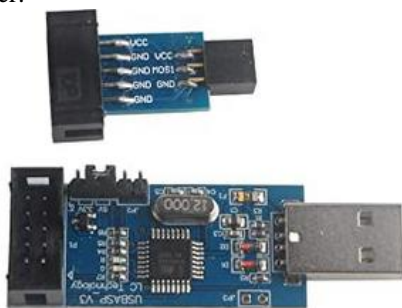
Fig. 13. AVR MCU Programmer
